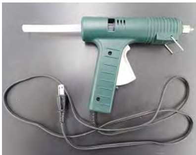
図2. グルーガンで使用するホットメルト。多くの製品の軟化点は80～100℃である。
