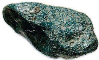
佐渡碧玉(さどへきぎょく) 新潟県佐渡畑野町猿八産：火山活動による熱水の影響で、石英中に銅成分がとけこんでできた石英の微小結晶の集合体。鉄分が含まれ赤いものは赤玉とよばれている。
