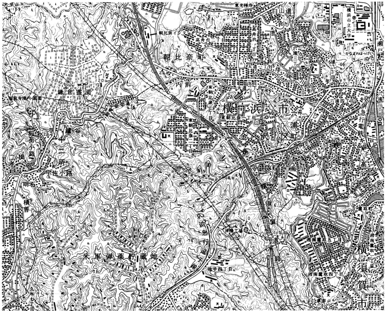
図2. 1983年測量の横浜市・横須賀市・鎌倉市・逗子市境界域付近（昭和60年国土地理院発行，1：25,000地形図，鎌倉より）。1968年当時と比較して，住宅地や霊園が拡大し，水域が変革され，横浜横須賀道路が地域を2分するなどの大変化がある一方で，逗子市の米軍弾薬貯蔵地はほとんど何も変わっていない。
