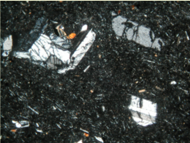
偏光顕微鏡写真 スケールは横が3.5mm (上 : 開放ポーラー, 下 : 直交ポーラー)
