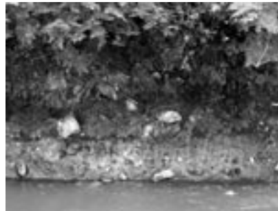
図2 凝灰角礫岩。非常に大きな安山岩レキが目立つ。写真撮影時はかなり水位が低下した状態。
