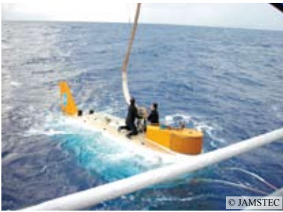
図5 ダイバーによってワイヤーとロープが外されているところ。
