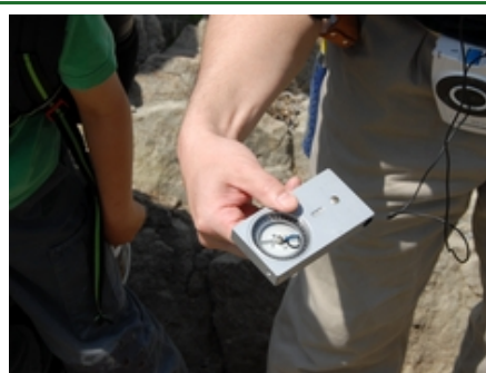
2.クリノメーターで地層の傾きを測定。
