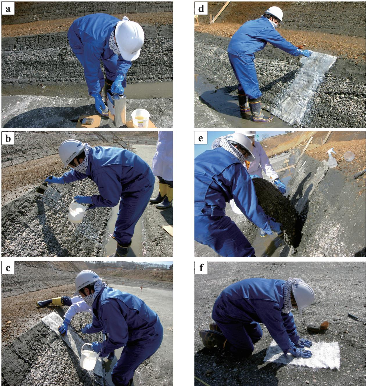
図2. 学芸員によるウレタン合成樹脂剤のトマック NS-10 を用いた剥ぎ取り作業。 a: トマックを必要量だけ容器にうつす。 b: 刷毛で丁寧にトマックを塗る。 c: タワシでガラス繊維を押さええて一体化させる。 d: 霧吹きで水をかける。 e: 丁寧に剥がし取る。 f: 水平面を剥ぎ取することもできる。
