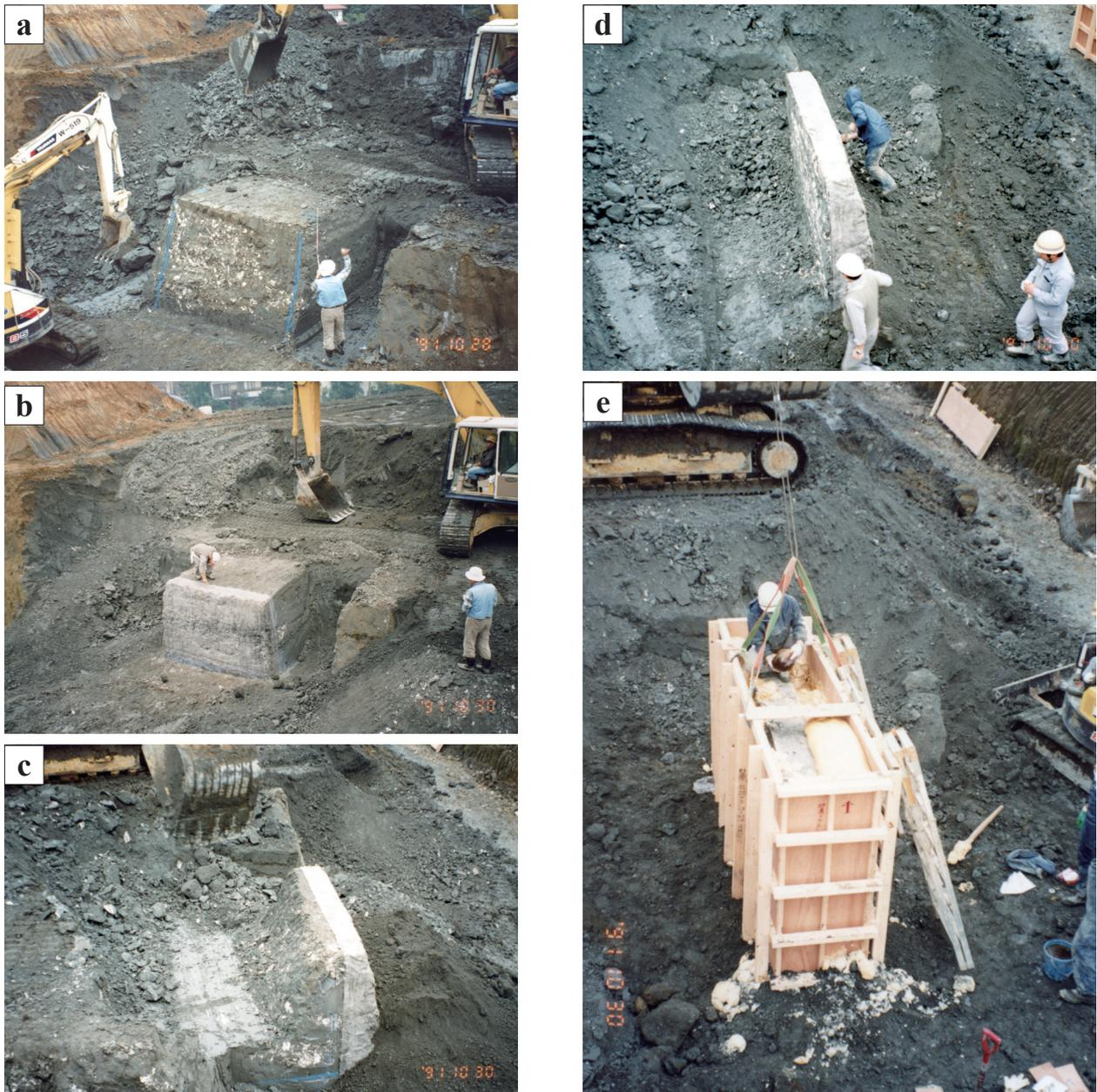
図8. 化石カキ礁を含む相模層群上倉田層の切り取り標本の収集作業（KPM-NP 9と同地点）。a: 重機で側面を削る。b: 収集する面に樹脂を噴き付け補強する。c: 裏面を削る。d: 削り終わったところ。e: 角材で梱包して取り上げる。
