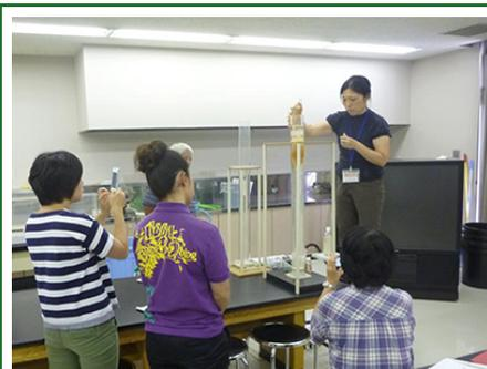
3アクリルチューブを使った実験で、粒子の沈降速度を計測。
