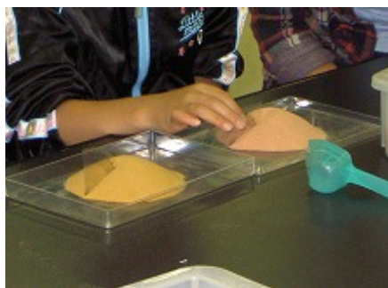
1.砂山の斜面の角度を測っています。
