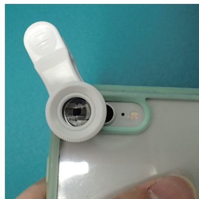
図2. 左：100円ショップの「スマートフォン用マクロレンズ」。右：スマートフォンに取り付けたところ。
