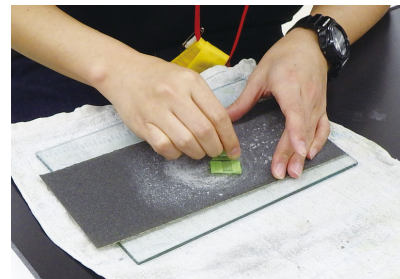
図5. スライドガラスに貼りつけた後、#80の紙やすりで磨く。養生テープでつまみと片減り防止がしてある。
