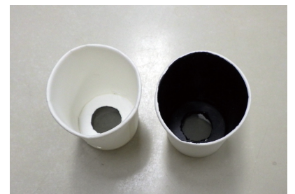
図9. 紙コップと偏光板でつくった岩石薄片の観察道具。
