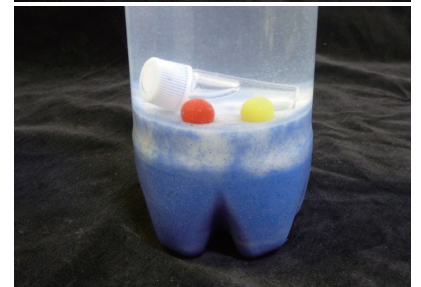
図10 液状化実験装置。上：実験前，下：実験後。青い砂が上へ噴き出し、マッシュピンは浮き上がり、小さなガラス瓶は倒れる。
