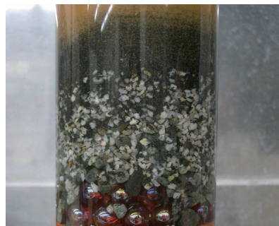
図7 実験で作った級化層理。水の中では粗い粒から順に沈む。直径8 cmのアクリルチューブで実験。
