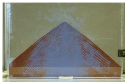
図3 より粗い赤い砂が、斜面先端（山のふもと）へと集まって縞模様をつくる。装置製作：松井理作氏（地学ボランティア）。
