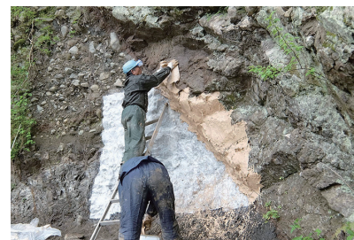
図3 左上から右下に走る断層をはさんで左側を剥ぎ取り、右側を型取り着色標本とした連続標本の製作。神奈川県足柄上郡山北町、平山断層。大島光春撮影。
