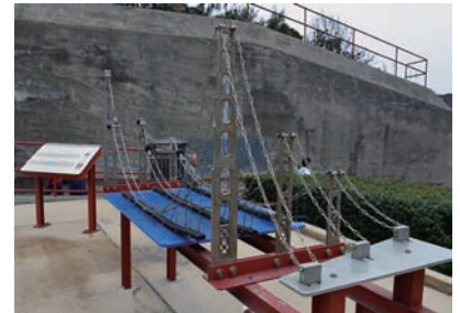
図11 ゴールデンゲート・ブリッジにあったエキスポラトリウム提供の実験装置。吊り橋の塔が高いほど張力が弱くてすむ。
