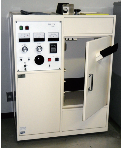
図1 軟X線の撮影装置。
