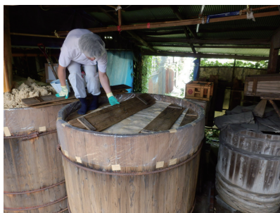
図 2-4c 板でふたをして、重石をのせる。
