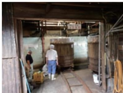
図 2-5 トロッコで発酵蔵へ運び入れ、熟成させる。
