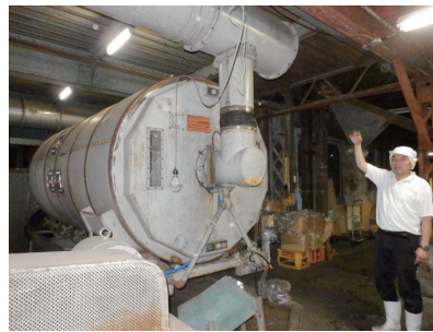
図 2-2 製麹機。円筒形の巨大な容器が回転し、米と麹を攪拌する。
