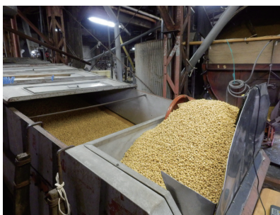
図 2-3b ベルトコンベヤーで運ばれる大豆。
