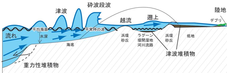
図2. 津波堆積物の分布の概念図.
