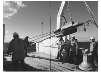
図2 熱海沖にてピストンコアラを海底に投入しようとしているところ。
