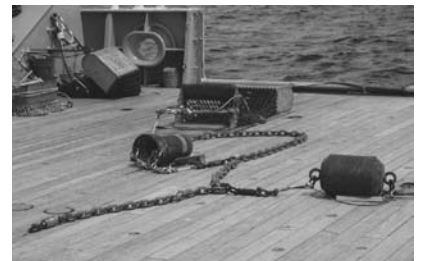
図3 組み上げられたドレッジ。右の円柱が200 kgの錘、奥に本体が繋がれている。左奥には予備が置かれている。写真は2007の白鳳丸での航海。
