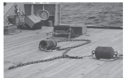
図3 組み上げられたドレッジ。右の円柱が200 kgの錘、奥に本体がつながれている。左奥には予備が置かれている。写真は2007の白鳳丸での航海。
