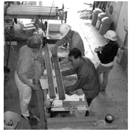
図6 縦に半分に切られた半割コア。半割される前のコアが奥(写真左上)に並ぶ。
