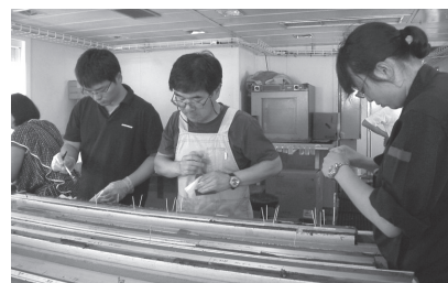
図7 希望箇所に楊枝をさし、試料を分取。
