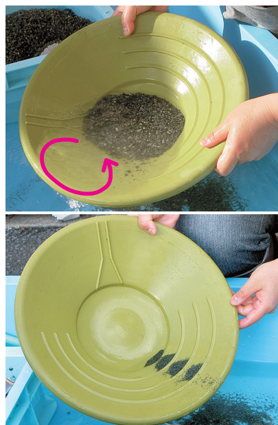
図2 パンニングの様子。比重の違いを利用して水中で砂を選りわけ。
