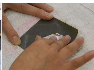
図3 耐水ペーパーで磨く。
