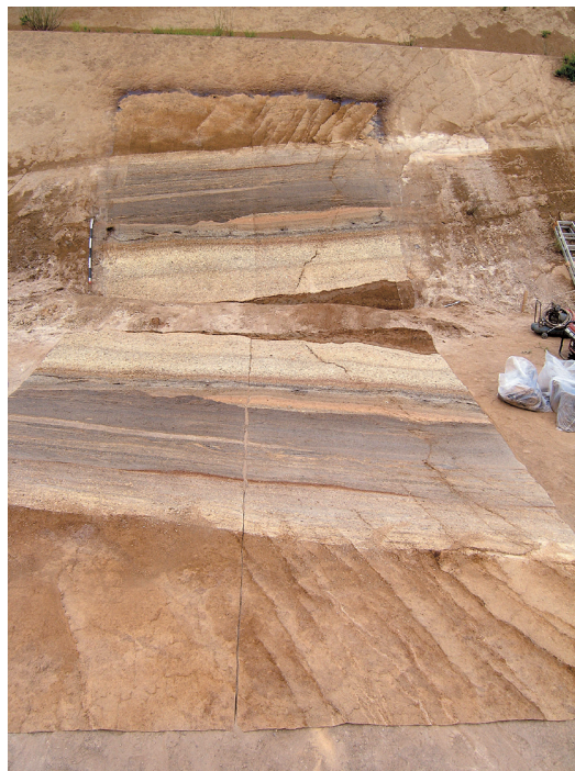
図3 箱根東京テフラの剥ぎ取り（伊勢原市高森）。奥が実際の露頭で、手前が剥ぎ取られた資料（鏡像のような関係になる）。鎌の柄の目盛りは20cm間隔。
