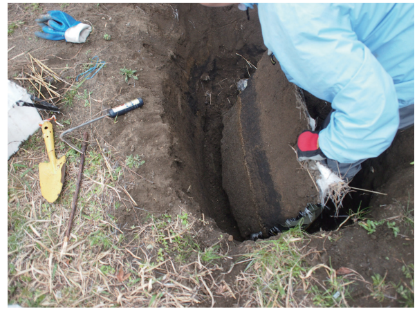
図 2. 割裂（上方から）に近い剥ぎ取り（KPM-NP 64，富士宝永スコリア，茅ヶ崎市）。
