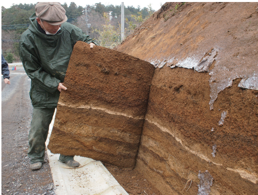
図 3. 90° 剥離に近い剥ぎ取り（KPM-NP 49，始良 Tn テフラ，厚木市）。
