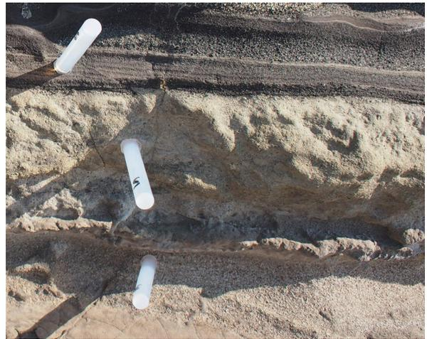
図4. 露頭面にスティックを接着する。
