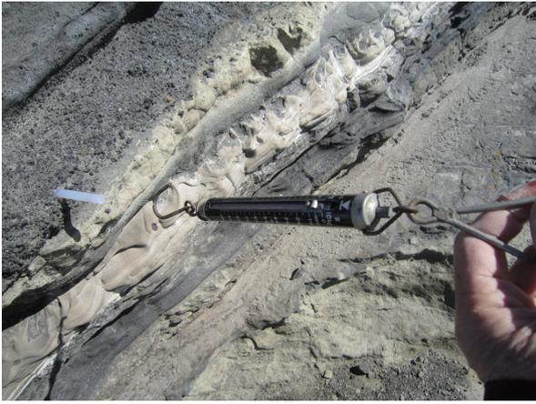
図 8. 城ヶ島での引張強度の測定.
