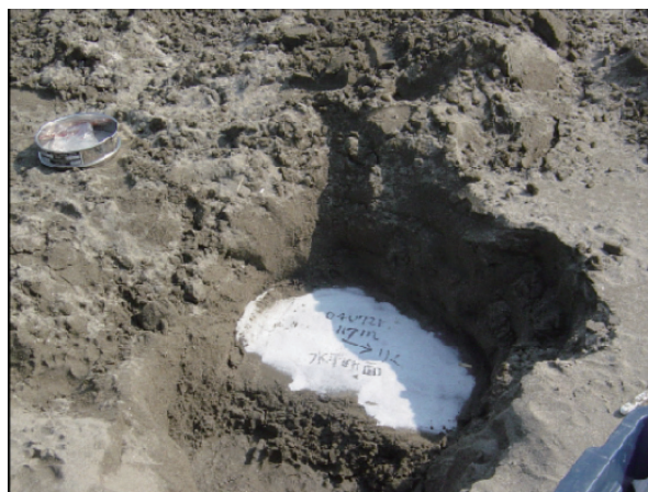
図 3. 砂浜海岸において、堆積物水平断面の剥ぎ取り標本を作製している様子。任意の深さまで掘り下げ、平坦な水平面を削り出し、剥ぎ取り用の樹脂を塗布する。2004 年 7 月 21 日、高知県幡多郡大方町（現・黒潮町）の入野海岸にて撮影。
