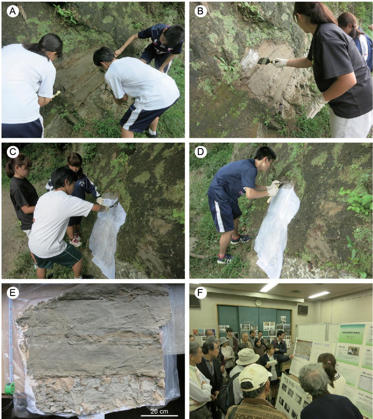
図2. A: ねじり鎌による地層の整形. B: トマック NS-10 の塗布. C: 寒冷紗の貼り付け. D: 標本のはぎ取り. E: 完成した
