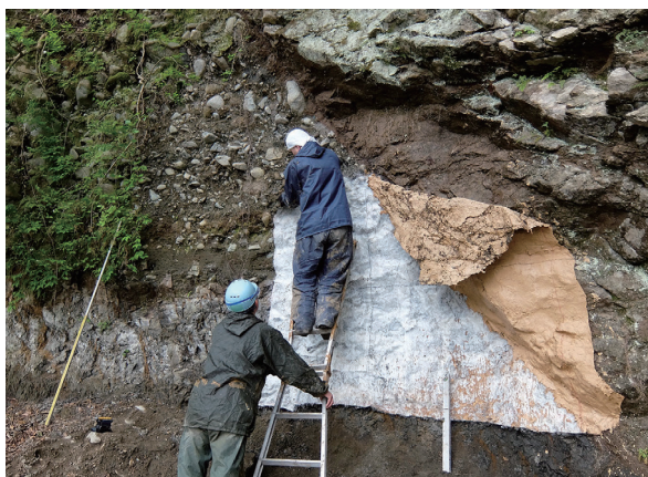
図 1d-2-3. 標本の採集の様子。露頭向かって左側は剥ぎ取り技法、右側は型取り技法を適用。
