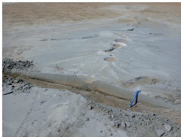
図 II-6-2. 標本製作のためにグラウンドを掘り込んで作った噴 砂丘の断面。
