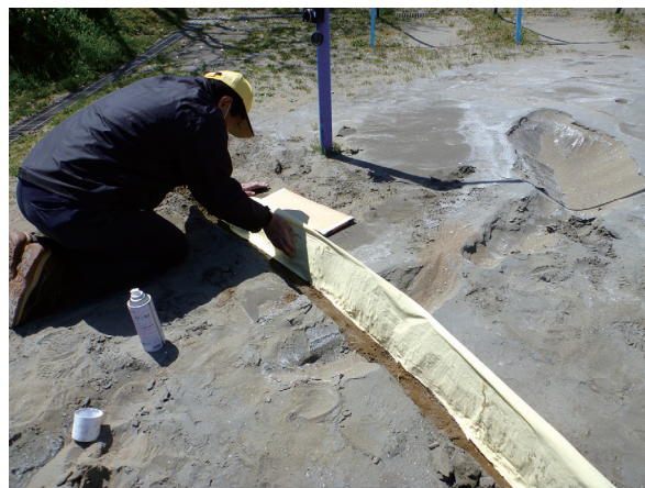
図 II-6-3. 標本の採取の様子 (スプレー式接着剤を使用, p.16 図 4 参照)。
