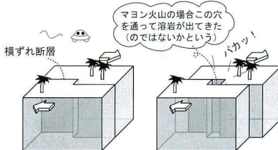
図4 プルアパートの出来方。2つの横ずれ断層が一直線上でつながらないとき両断層の間にプルアパートと呼ばれる構造ができる。
