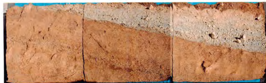
図3. 完成した剥ぎ取り標本。剥ぎ取り標本は、巨大なため3つに分割されている。標本の、左上から右下にかけて見られる白色の部分がHk-Km3火砕流。剥ぎ取り標本のため、左右が逆になっていることに注意。
