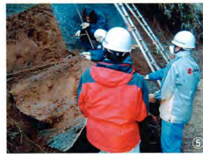
図2. 剥ぎ取りができるまで。 ①露頭を剥ぎ取りやすいように整形しているところ ②整形した露頭. 右上から左中にかけて火砕流が見られる ③接着剤と樹脂を露頭に噴き付ける ④露頭に接着した樹脂(乾燥中) ⑤固結した樹脂を地層とともに剥がし取る
