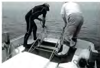
図1. 調査に使用した漁具、この漁具を海底に沈め、曳航して生物を採集する。
