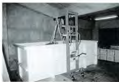
図2. 大型魚類標本用のコンテナと耐荷重500kgのハンドリフター
