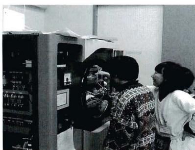
図2 真空凍結乾燥機による標本作成
