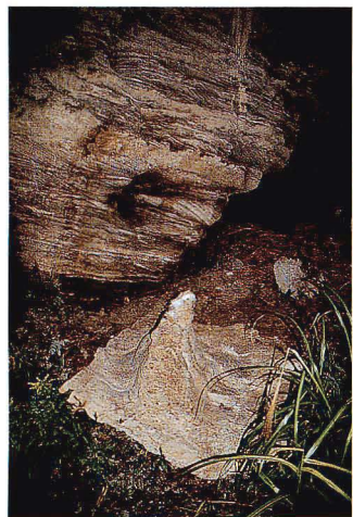
地層の立体的なはぎ取り 露頭では凹の部分がはぎ取り資料では凸になる。
