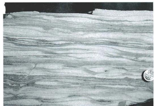
写真3. 堆積面に垂直に切断した面に見られる波状と羽根状の堆積模様
