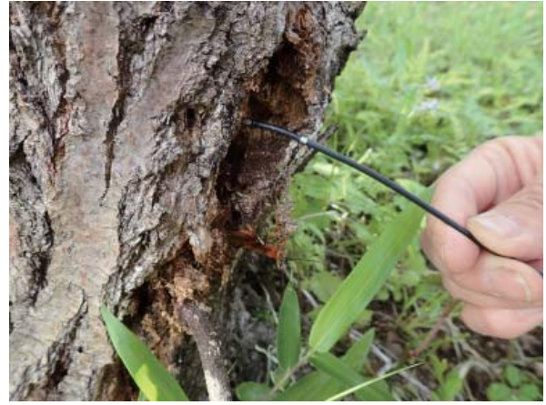
図 2. 工業用内視鏡を使った調査、カミキリムシ幼虫の坑道に内視鏡を挿入しているところ。
