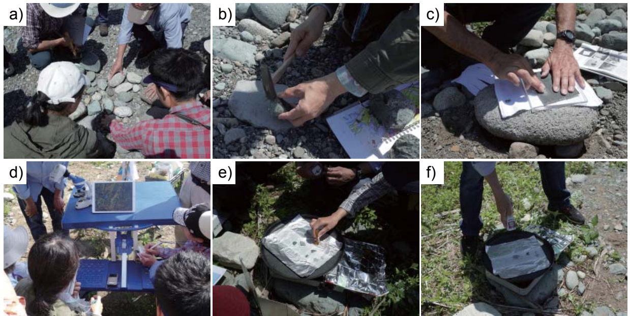
図 8. 野外で岩石薄片を作製し、観察した講座. a: 河原の岩石を解説する. b: 小型のハンマーで石片を作製する. c: 紙やすりで石片を磨く. d: 偏光顕微鏡にデジタル顕微鏡カメラを装着し解説. e: レークサイドセメントでスライドガラスと石片を接着. f: 鉄板の温度を赤外線温度計で測定.
