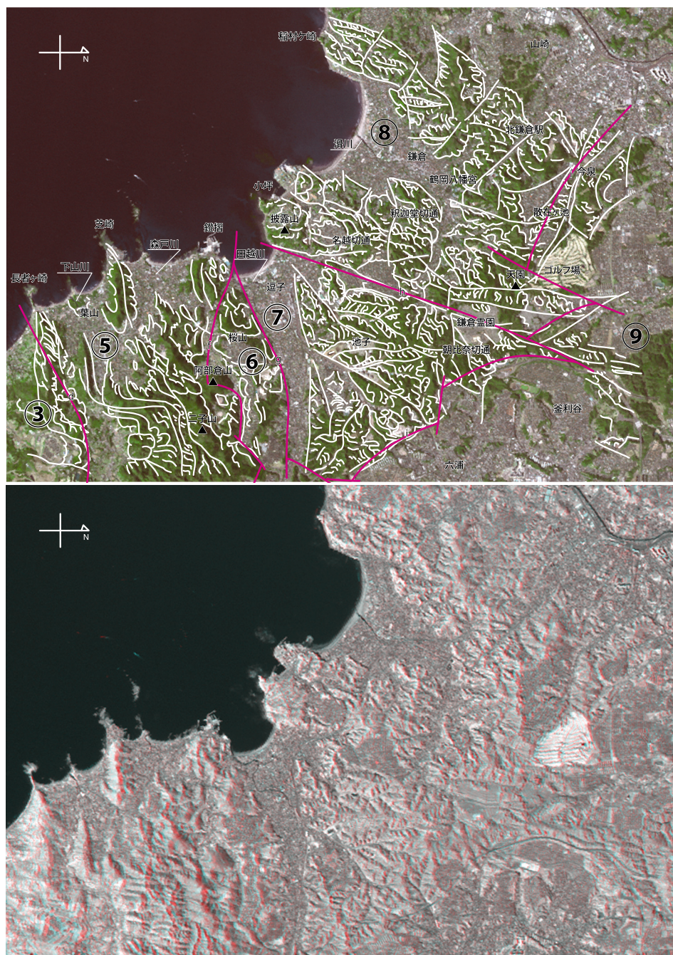
図7. 余色立体図から読み取った三浦半島北部の構造 (上: 構造を記したナチュラルカラー画像、下: 余色立体図)
