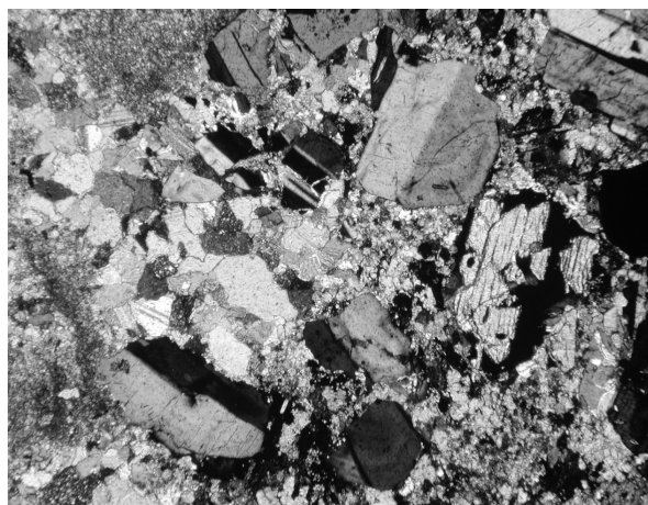
3r 鈦物粒を含む石灰質砂岩 .( 直交ニコル )
