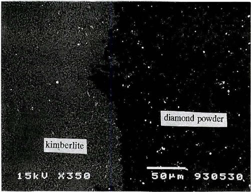
図 3. 実験生成物の BSI 写真 (全体). 左側はキンバライトソリダス。右側がダイヤモンド粉末。ダイヤモンド粉末中の白く明るい部分が部分融解によって生じたメルト。
