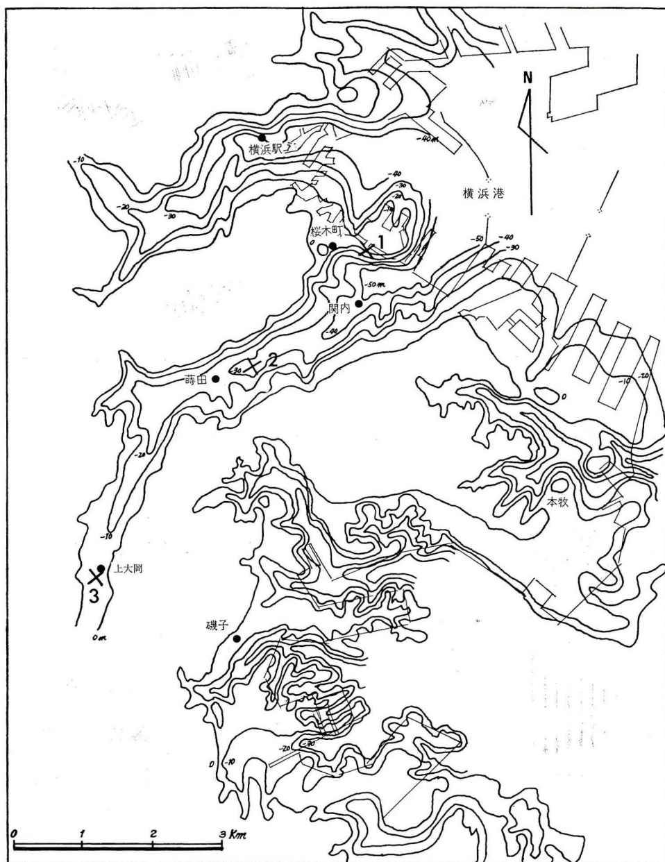
第8図 横浜港周辺の沖積層の基底面図（復興局：1929，三木ほか：1966，に加筆）
