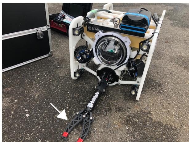
図 3. 調査に使用した水中ドローン DiveUnit300. 本体サイズ: 410 x 375 x 639.5 mm. 重量: 28 kg. マニピレータを搭載 (白矢印).
