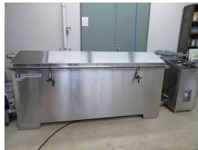
図4. 晒骨機。通称“お風呂”。中に骨格を入れて稼働させ、骨格標本を作製する。
