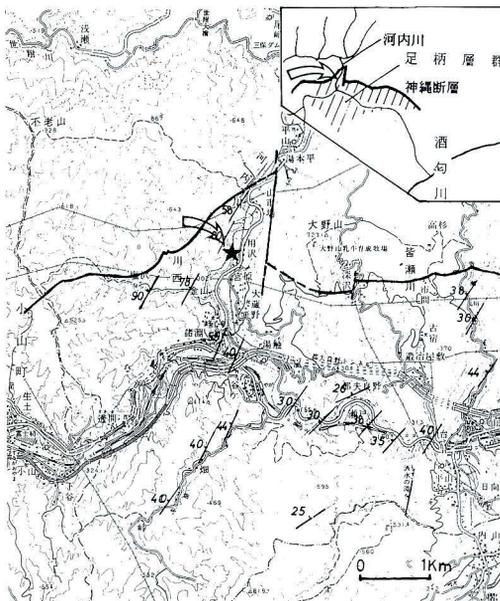
図1. 河内川と神縄逆断層のトレースおよび調査地点(矢印)
